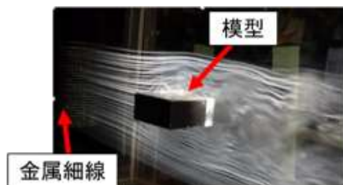
写真-1 流れの可視化実験状況
