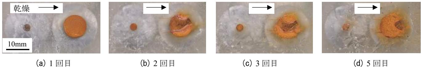
図-2 乾燥後の滯水表面の外観 (乾燥方向 :  $\phi 3 \rightarrow 10\text{mm}$ )
