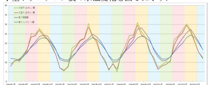
図 1. 材質別および地下と地上における水温変動
