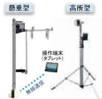
図1 橋梁点検ロボットカメラ
