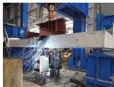
写真-1 荷重試験状況
