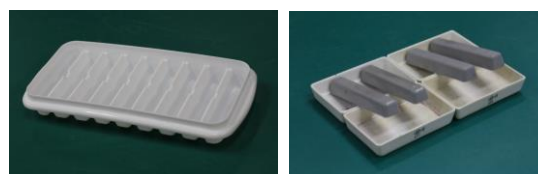
図 2 棒状ペースト供試体用の型枠ならびに加熱前の状態
