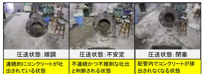
写真-1 圧送実験における各圧送状態
