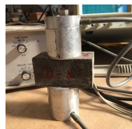
図-2 超音波伝搬速度の測定状況
