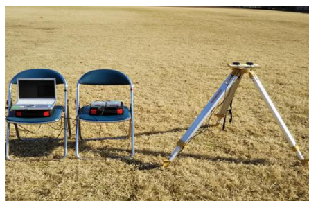
図-1 GNSS 観測状況
