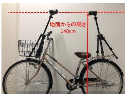
図1 自転車のカメラを搭載した様子
