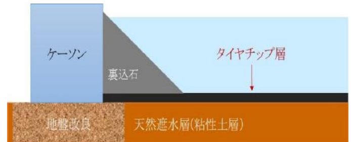
図-1 タイヤチップを用いた海面処分場の構造図
