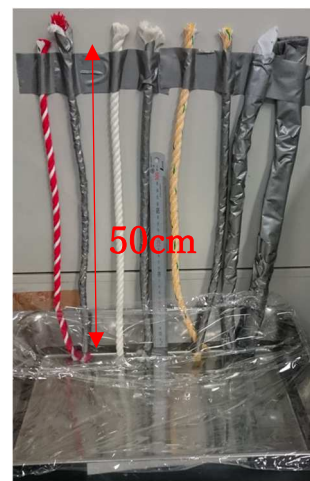
写真1 多種のひもの吸水実験
