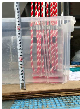
写真 2 吸水試験の下端
