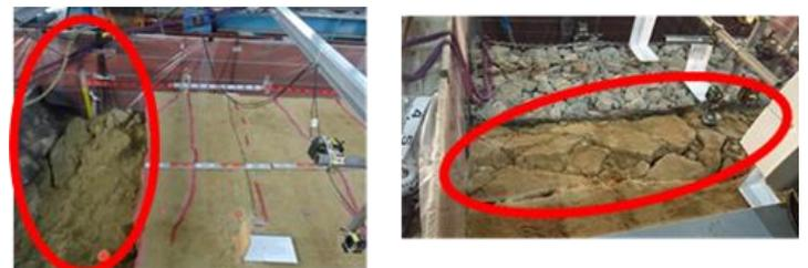
写真-1 加振終了後の蛇籠擁壁近傍の地盤崩壊およびクラック発生箇所 (写真左: 直立式 写真右: もたれ式)
