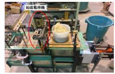
図 4. 設置された鉛直載荷機
