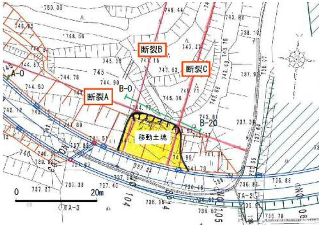
図-3 調査位置図および断裂分布図
