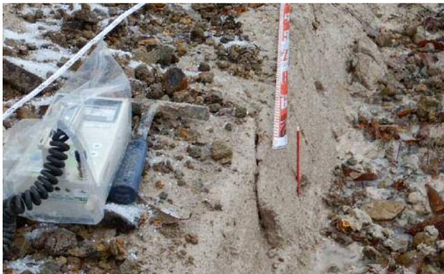
図-4 のり尻で見られる断裂 A の形態（裂か）
