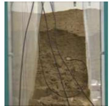
写真-2 Case2-1の崩壊の様子
