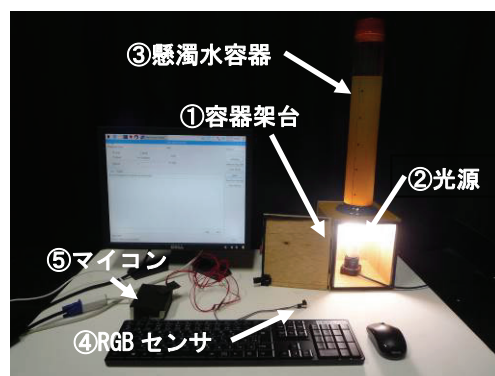
写真-1 本研究で用いた汚濁度測定実験装置の概要
