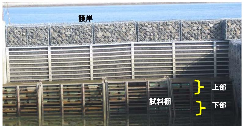
図-1 護岸背面の長期養生用の試料棚の状況
