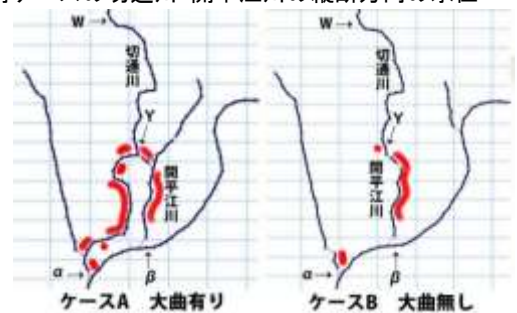
図-5 両ケースの越流箇所
