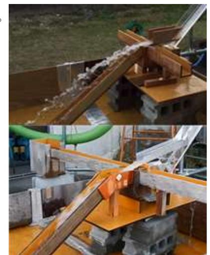
図-5 200年確率降雨相当時の流況 水平ジャンプ台(上)、傾斜ジャンプ台(下)
