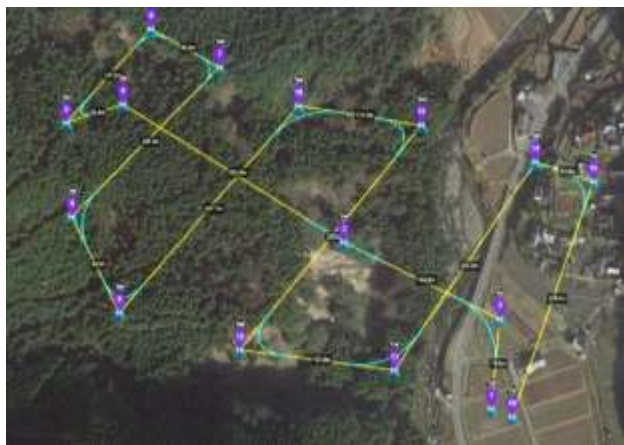
図3 日田市小野地区の自動航行の経路図
