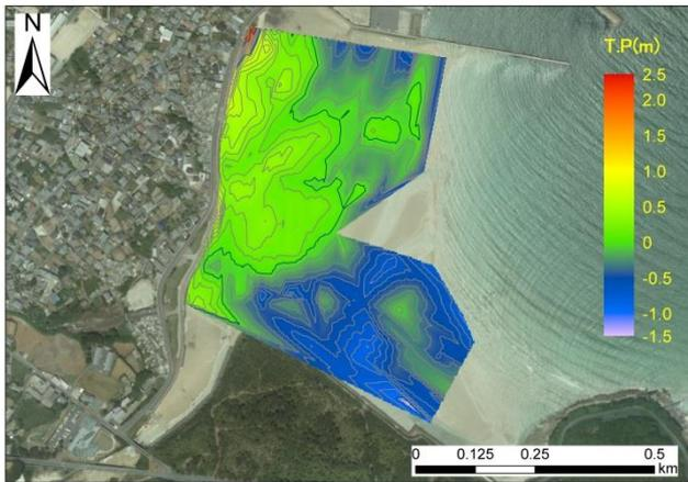
図-3 現地測量による標高図 (2017年10月17-18日)
