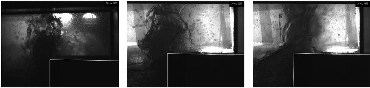
図-3 直立護岸前面での波の打上げ状況
