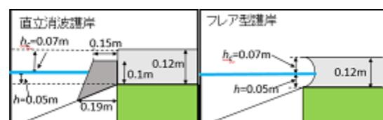
図-2 護岸断面寸法
