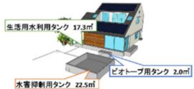
図-1 雨水利用実験住宅タンク配置
