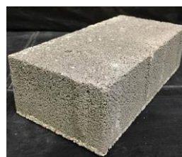
写真-2 改良ILB外観
