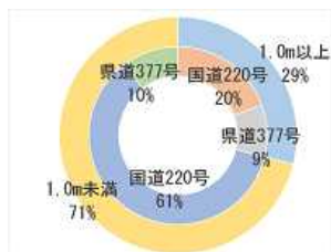
図-7 下り方向の路肩幅員
