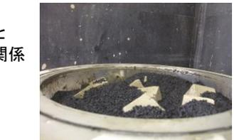
写真-4 粒径  $1.0<d<3.0$ 、層厚  $5\text{cm}$  のタイヤチップの着底状況
