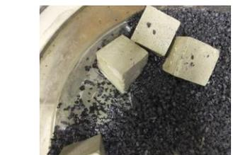
写真-3 粒径  $3.0<d<5.0$ 、層厚  $3\text{cm}$  のタイヤチップの着底状況
