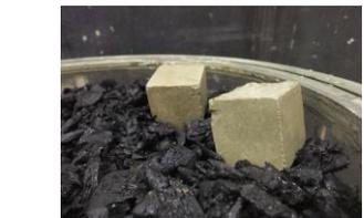
写真-5 粒径  $d<32$ 、層厚  $5\text{cm}$  のタイヤチップの着底状況
