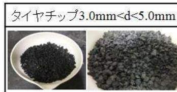
写真-2 実験試料
