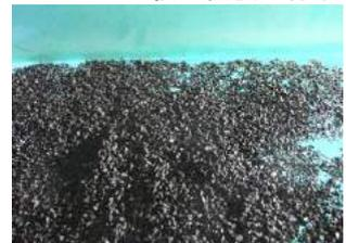
写真-6 水面に浮かぶタイヤチップ
