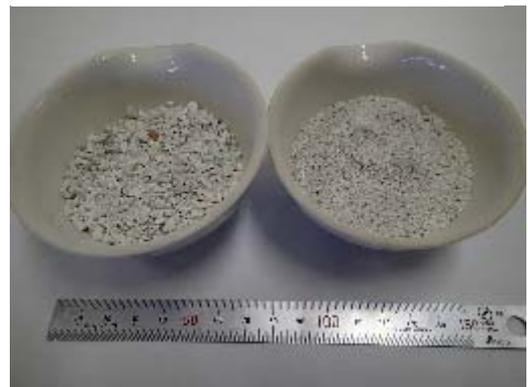
写真-2 陶磁器破砕片(左:粒径 2~4mm、右:粒径 0.9mm)
