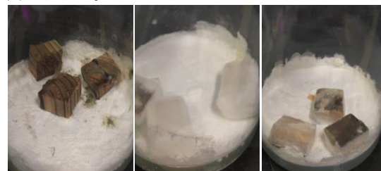
(a)スギ (b)自然乾燥竹 (c)絶乾竹 写真-1 腐朽培養2ヶ月後の様子(オオウズラタケ)
