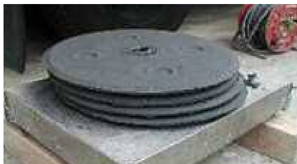
図-2 4トン車載型高圧 PFP 機で製造された脱水固化土
