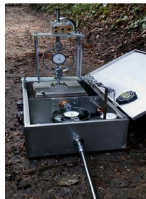
写真-1 現場一面せん断試験装置
