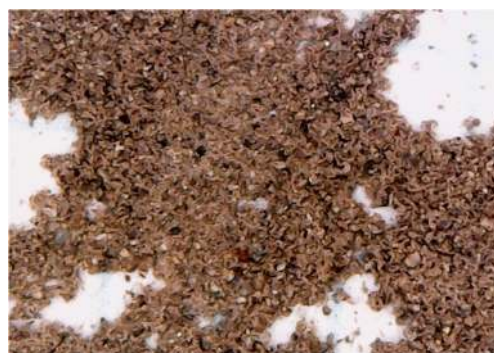
写真-5 粒子状況 ( \phi \leq 75\mu\text{m} )
