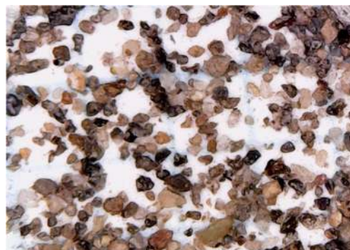
写真-3 粒子状況 ( 106\mu\text{m}\sim 250\mu\text{m} )
