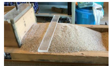
図4. 崩壊後の隆起した盛土
