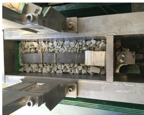
写真 - 4 小型引抜き試験状況
