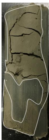
写真-2 水平攪拌の影響を伴う供試体の状況
