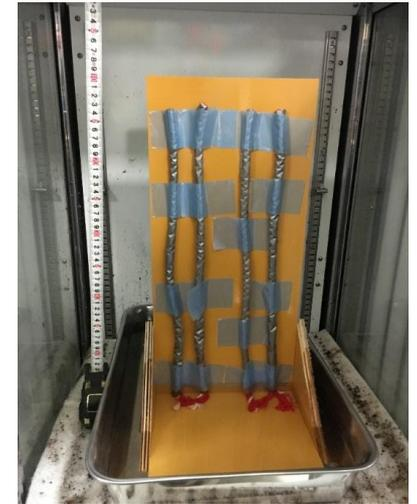
写真1 ひもの吸水実験の様子
