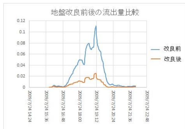
図-3 地盤改良前後の流出量比較
