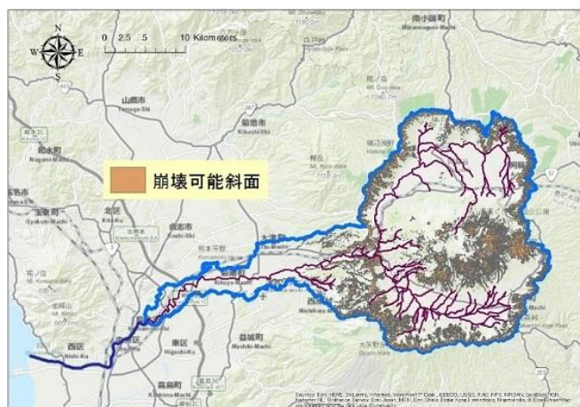
図-2 推定された崩壊可能斜面の分布
