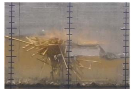
写真-1 欄干を有したピアのない橋梁模型による流木捕捉状況 ( q=347\text{cm}^2/\text{s} , N=405 本, 捕捉本数 356 本)
