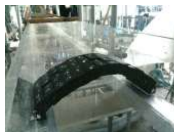
写真3 実験水路と石アーチ輪石模型
