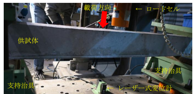
写真-1 供試体設置状況（底面補強供試体の場合）
