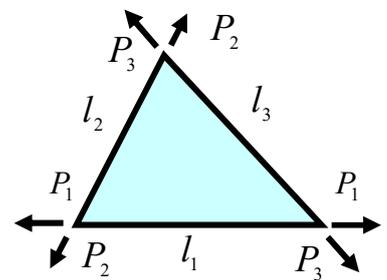
図-1 変形時の三角形定ひずみ要素
