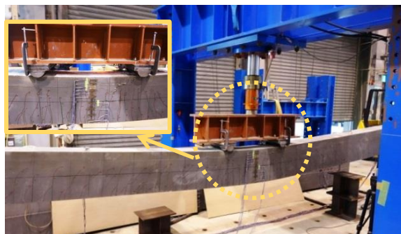
写真-2 No.1 の終局状況
