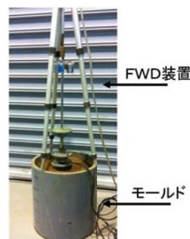
図 3 改良型 FWD 装置の設置状況
