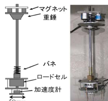
図 1 改良型 FWD 装置の概要
