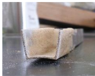
図4 実験後の模型鋼矢板
