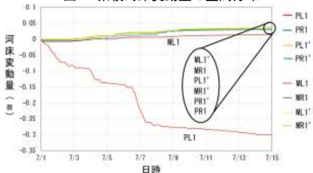
図-5 河口から2km地点の河床変動量の時間変化
