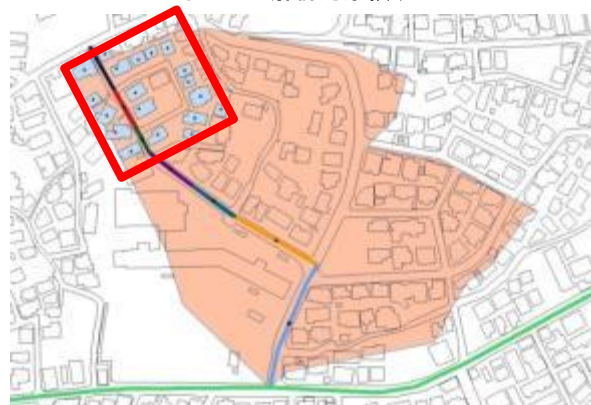
図－3 対象管路と流出抑制域
