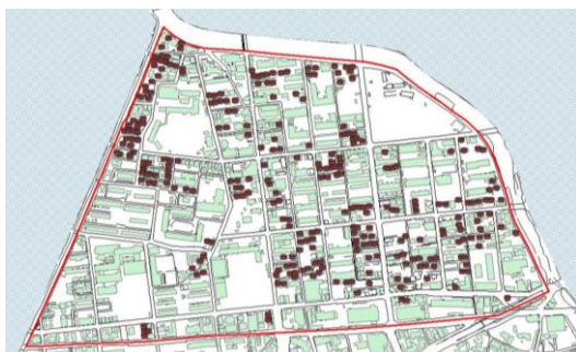
図-4 雨水貯留タンク設置位置
