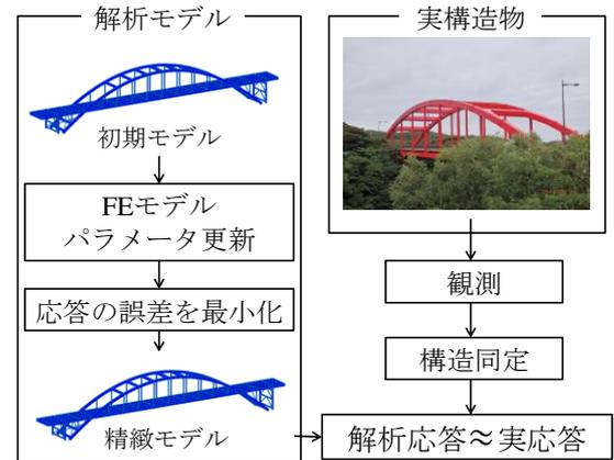
図-1 FEモデルの精緻化イメージ
