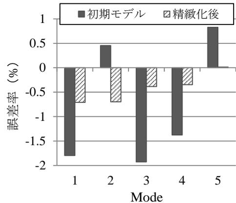
図-5 固有振動数の誤差率の比較
